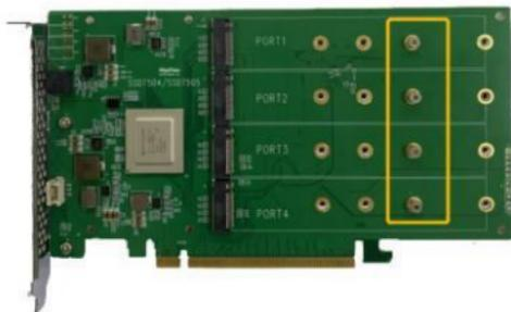
步骤 4. 请拆下SSD7505右侧的螺钉
