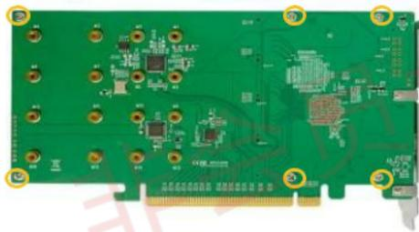
**注意：** 确保铝盖与控制器板（PCB）正确对齐，并与散热垫完全接触，然后再将其重新固定到SSD7505上。如果盖安装不当，风扇和散热垫将无法充分冷却NVMe SSD和控制器组件，这可能会导致SSD或控制器硬件损坏、性能损失、输入/输出不稳定和数据丢失。
