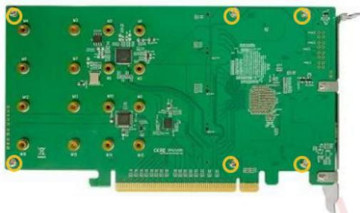
拆卸螺钉后，小心地从SSD7505上取下散热器。
