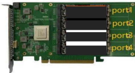
步骤 7. 安装完所有SSD后，请更换散热器
